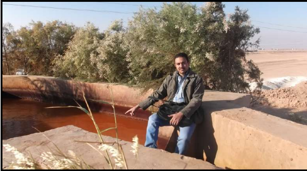
صورة (١٣) أكاسيد الحديد (الحميرة) في المياه الجوفية ببئر ١٥ بسهل الزيات بمركز بلاط عام ٢٠١٥م
